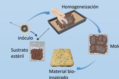
Figura 7. Esquema de la preparación de muestras de materiales bio-inspirados. Se agrega el inóculo en el sustrato nutritivo previamente esterilizado y se mantiene en incubación, después se procede a la homogeneización, posteriormente la mezcla se coloca en un molde y se mantiene en incubación. Finalmente el bloque se hornea a 60°C durante 8 horas. Una vez que se obtengan las muestras se medirán las propiedades físicas de los materiales.
